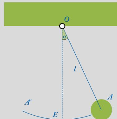
Si se desplaza la masa desde la posición de equilibrio  $E$  hasta la posición  $A$  el hilo forma un ángulo  $\alpha$  con la vertical. Al soltar la masa, oscilará en un plano vertical ya que se mueve sobre un arco de circunferencia bajo la acción de su peso y la tensión de la cuerda, describiendo un movimiento armónico simple (m.a.s.). El periodo m.a.s. se define como el tiempo que tarda el péndulo en hacer una oscilación completa (desde que sale de la posición  $A$  hasta que vuelve a ella).
